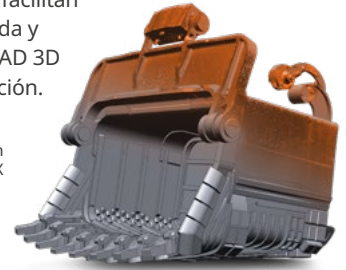
Un modelo sólido paramétrico creado en Geomagic Design X
